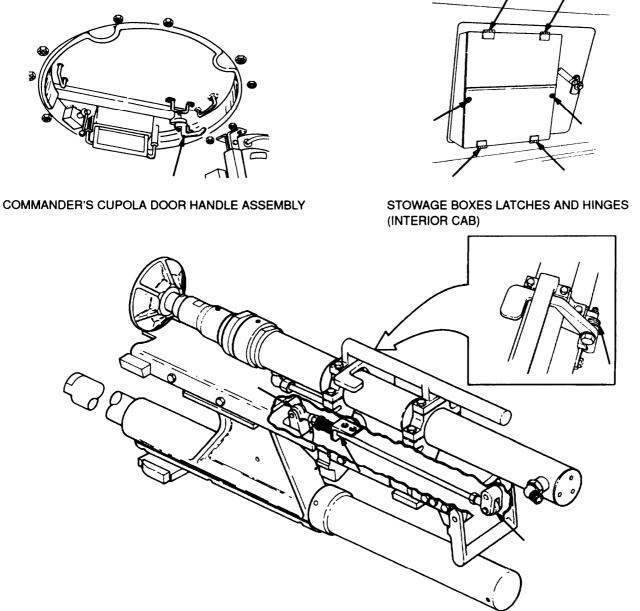
RAMMER ROD END BEARINGS, ANGLE BRACKET, AND LOCK-RELEASE LEVER
