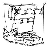
HULL AMMUNITION RACK HINGES
